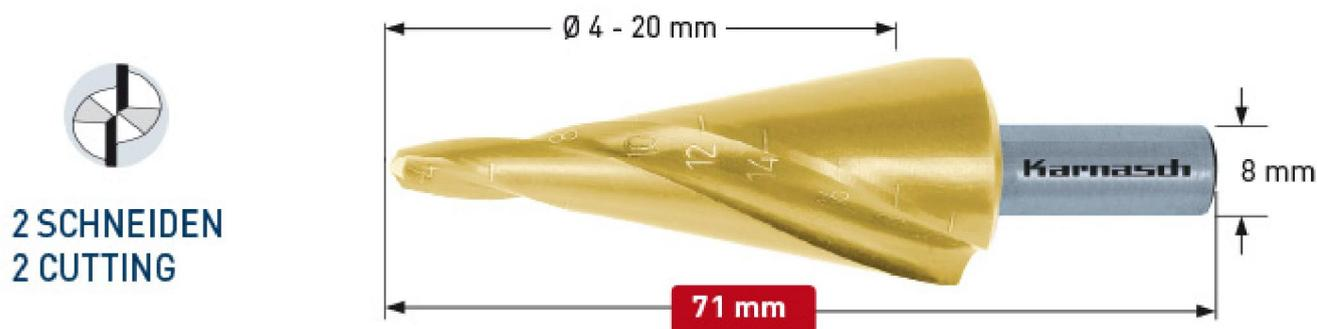
Изготовлены из высоколегированной стали HSS-XE для достижения твердости поверхности до 68 HRC. С износостойким покрытием TiN-GOLD. Имеют режущую кромку 35°. Легкое сверление ручной дрелью листового металла до 4 мм.
