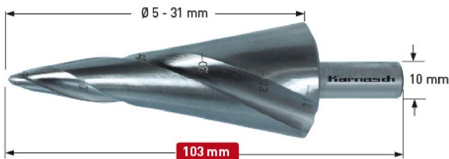
Изготовлены из высоколегированной стали HSS-XE для достижения твердости поверхности до 68 HRC. Имеют режущую кромку 35°. Легкое сверление ручной дрелью листового металла до 4 мм.
