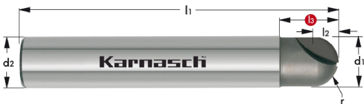
Твёрдосплавная сферическая фреза с CVD вставкой для высокоскоростной обработки, особо длинная
